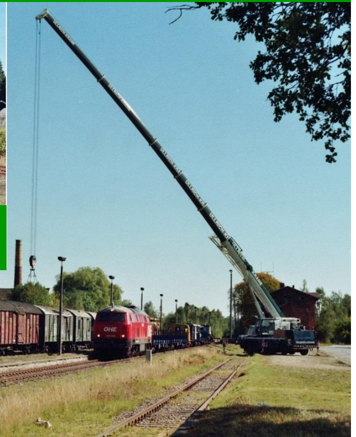
Wiederbelebung des Bahnhofs in Seelingstädt an der Eisenbahnstrecke Werdau/West – Wünschendorf/Elster am 01.10.2015. Entladung des Schienendrehkrans SDK 5 023 des ehemaligen Raw Zwickau und Rangierarbeiten bei schönstem Wetter. © A.A
